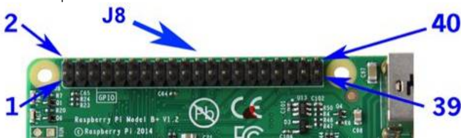
Numerazione fisica dell'header, serve per identificare un pin sull'header
